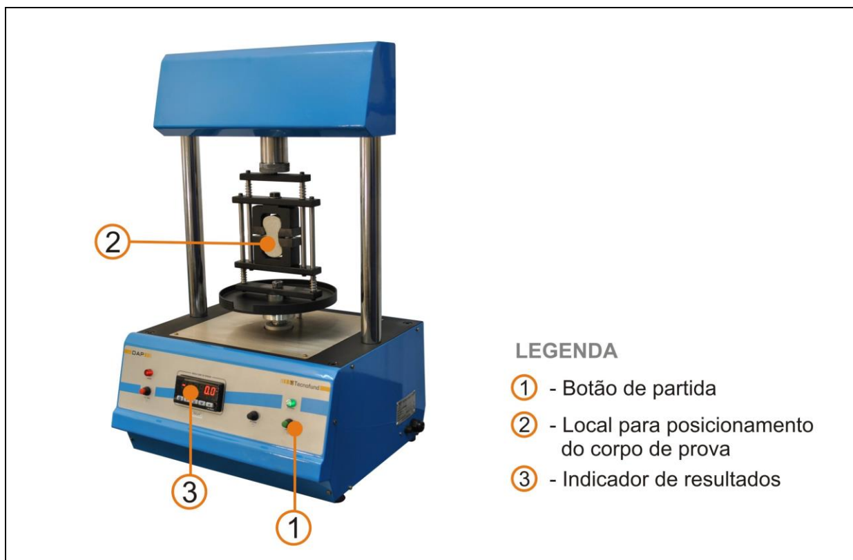
Figura 2 – Foto ilustrativa de uma máquina de ensaios para ensaio de resistência à tração.
