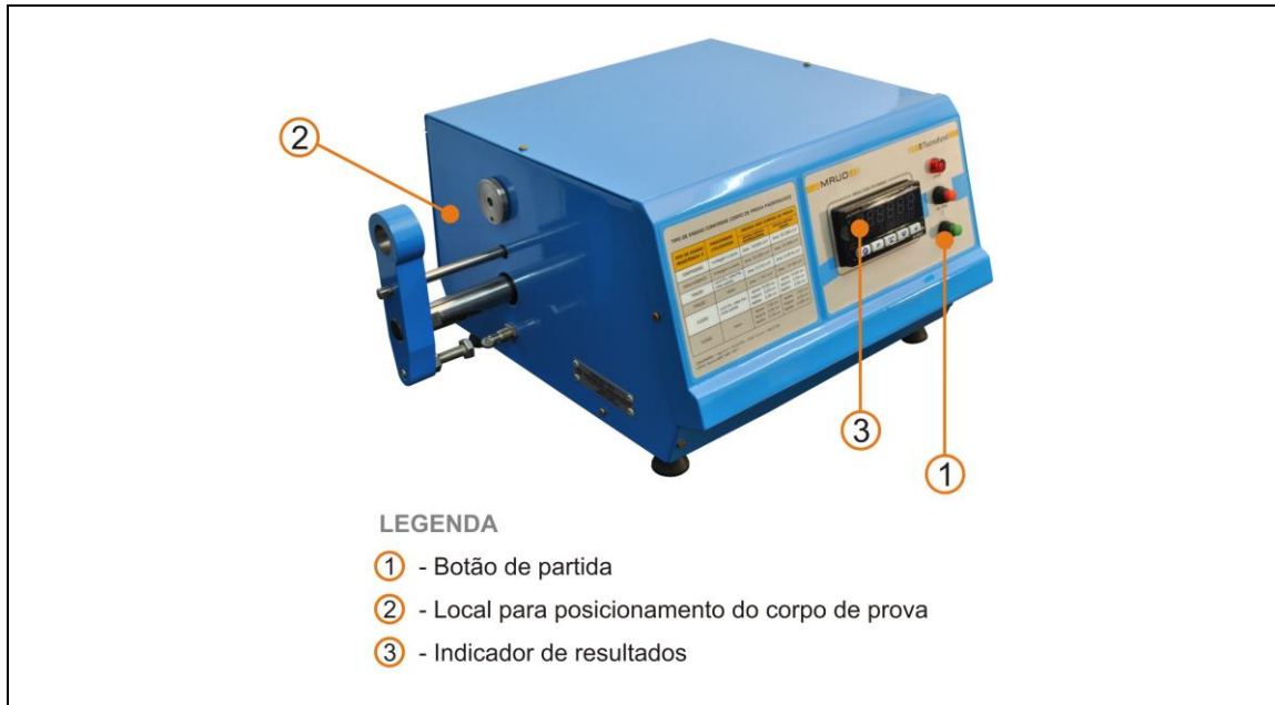
Figura 1 – Foto ilustrativa de uma máquina de resistência para areias de moldagem.
